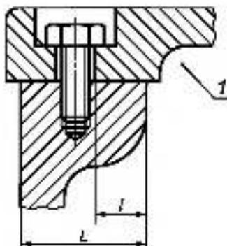
Рисунок 5 — Отверстия на поверхности плоских соединений (пример 3)
