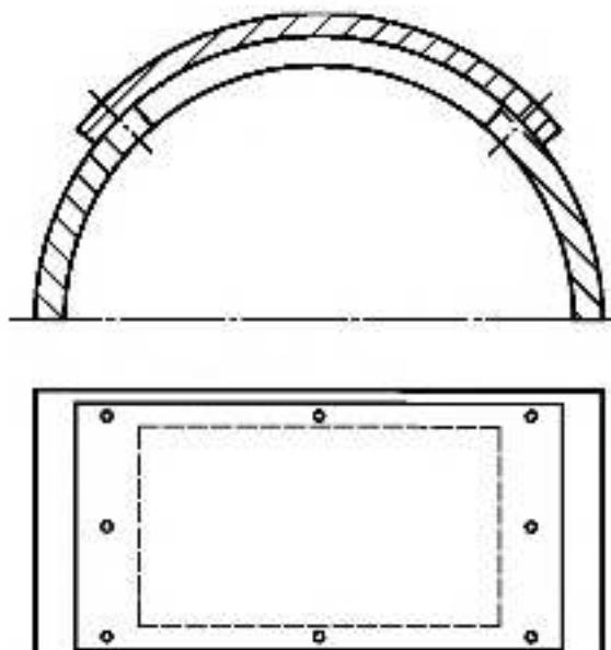
Рисунок 9а — Пример соединения с частично цилиндрическими поверхностями
