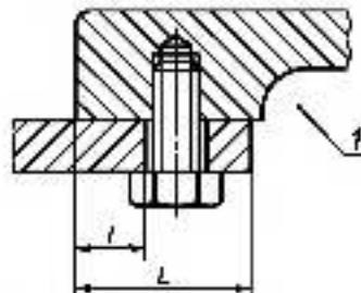
Рисунок 4 — Отверстия на поверхностях плоских соединений (рисунок 2)
