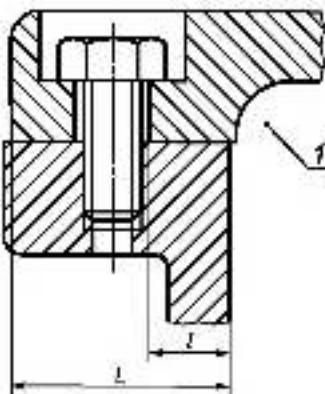
Рисунок 3 — Отверстия на плоскостях плоских соединений (таблица 1)
