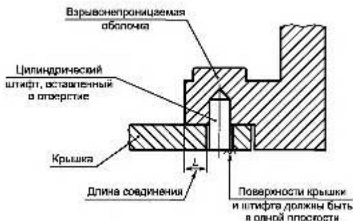
Рисунок 1 — Пример конструкции для косвенной проверки взрывонепроницаемого соединения группы I
