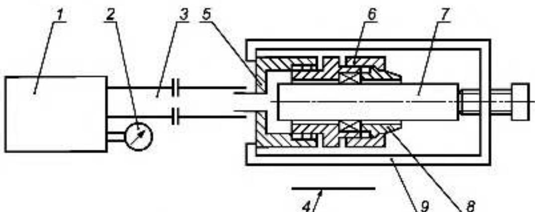
1 — гидравлический насос; 2 — манометр; 3 — рукоятка; 4 — проникающий биметалл; 5 — измерительный прибор; 6 — уплотнительное кольцо; 7 — оправа/гильза с кристаллической оплёткой; 8 — нажимной элемент; 9 — измерительное устройство
