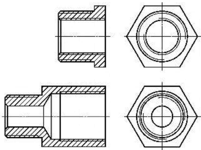
Рисунок С.3 — Примеры разборных Ex-изоляторов
