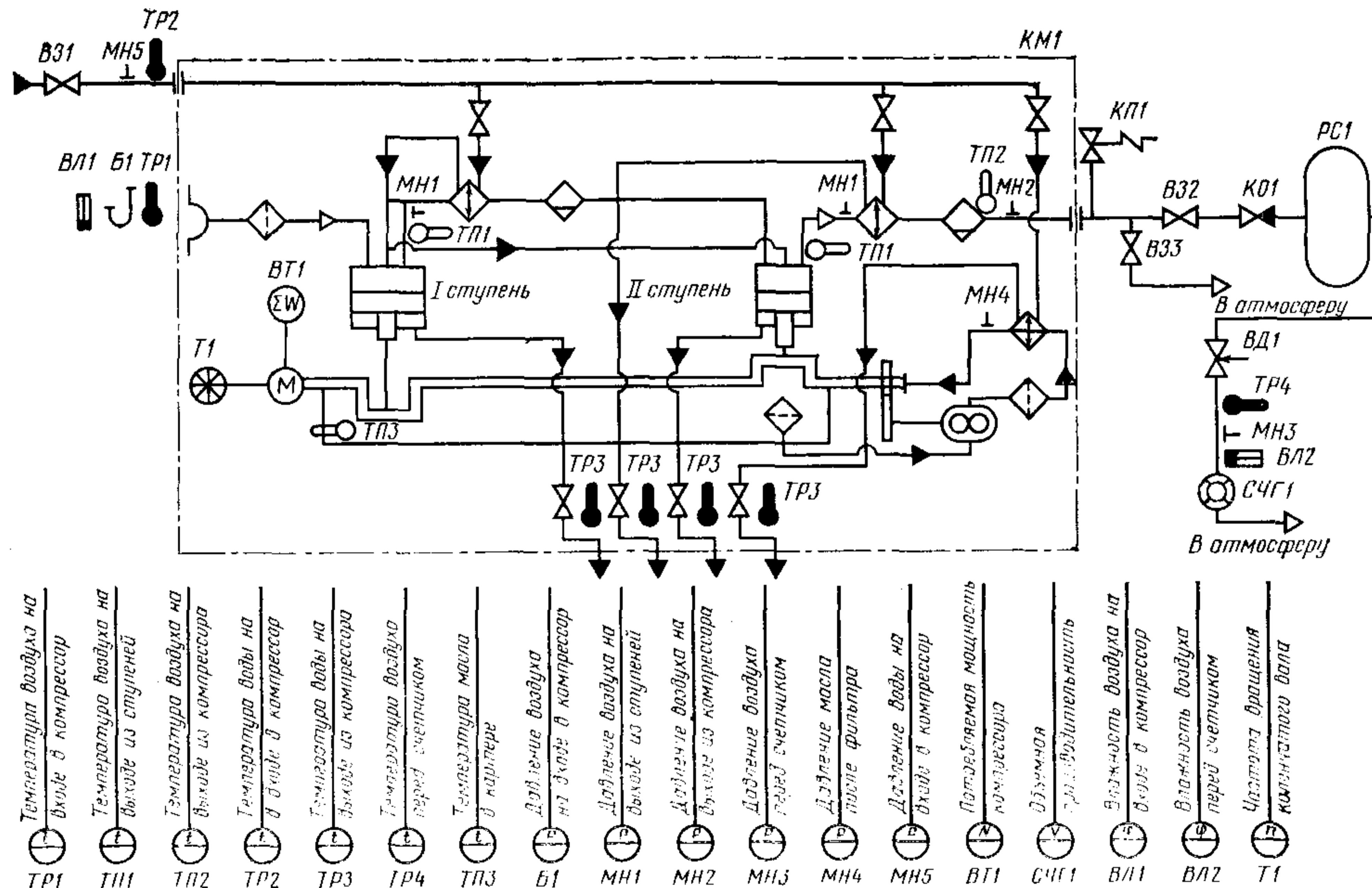
**Б1—барометр; ВТ1—ваттметр; ВЛ1, ВЛ2—влагомеры; ВД1—дросселирующий вентиль; В31—В33—запорные вентили; КМ1—компрессор; КП1—предохранительный клапан; КО1—обратный клапан; МН1—МН5—манометры; РС1—ресивер; СЧГ1—счетчик газа; Т1—тахометр; ТР1—ТР4—рутные термометры; ТП1—ТП3—термопары**
