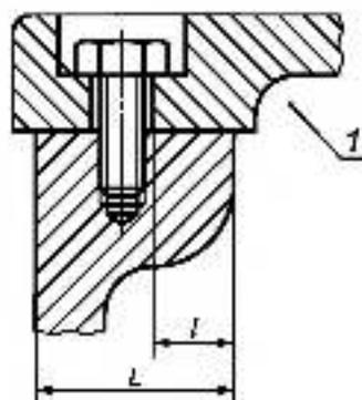
Рисунок 5 Отверстия на поверхностях плоских соединений (пример 3)
