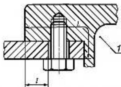
Рисунок 8 Отверстия на поверхностях плоскоцилиндрических соединений (пример 3)
