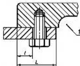
Рисунок 4 — Отверстия на поверхности цилиндрических соединений (таблица 2)
