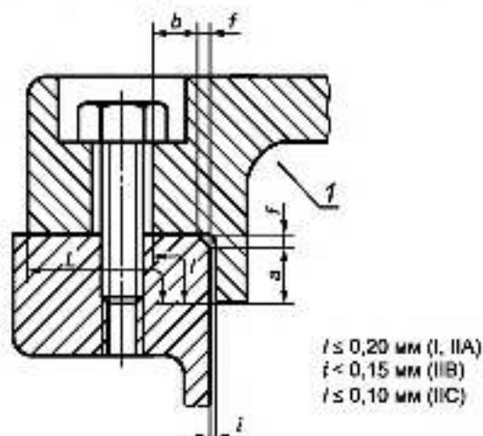
Рисунок 6 Отверстия на поверхностях плоскоцилиндрических соединений (пример 1)
