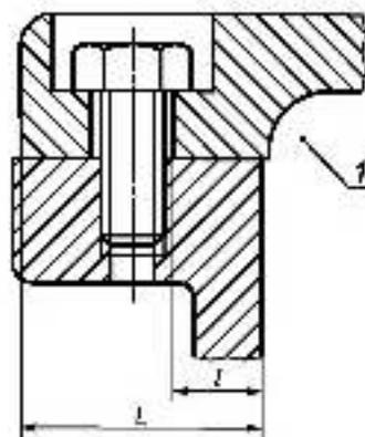
Рисунок 3 — Отверстия на поверхности плоских соединений (таблица 1)
