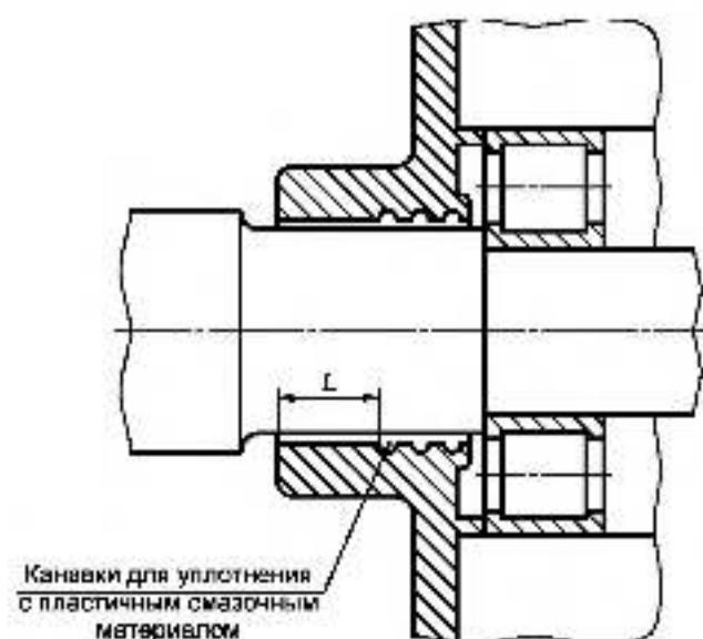
Рисунок 17 — Цилиндрическое соединение для валов вращающихся электрических машин
