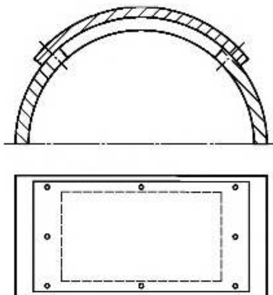
Рисунок 9а — Пример соединения с частично цилиндрическими поверхностями
