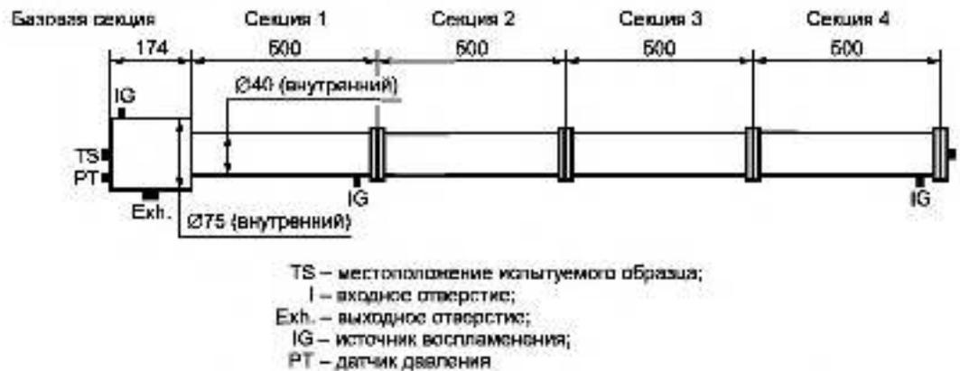
Рисунок 21 — Установка для испытаний дыхательных и дренажных устройств
