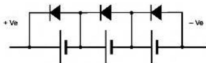
Рисунок E.1 — Схема подключения диодов из трех элементов, соединенных последовательно
