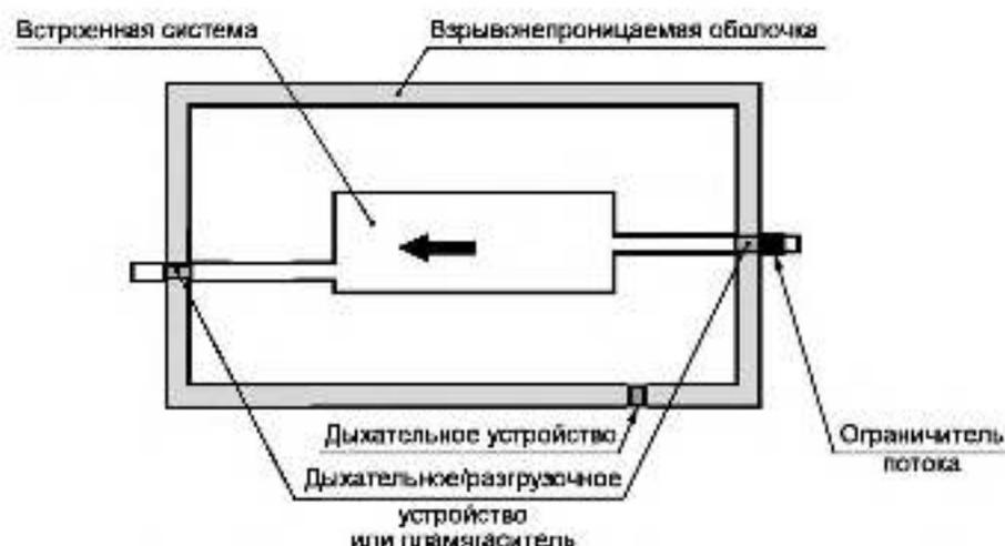
Рисунок G.1 — Взрывонепроницаемая оболочка со встроенной системой
