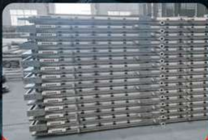
Фильтровальные плиты как для горизонтальных фильтр-прессов, так и для вертикальных (башенных) производства Larox, Metso, Roxia.
