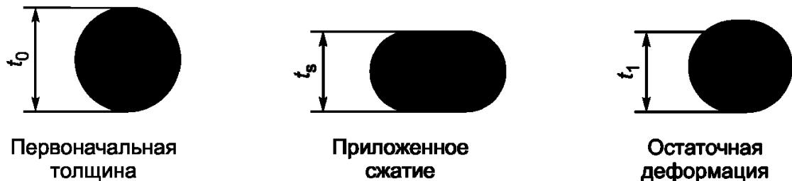
Рисунок 6 - Остаточная деформация при сжатии уплотнительного кольца
